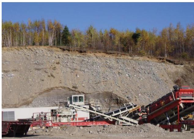
Figure 15 : Extraction de sable et gravier sur l'esker de Barraute<sup>109</sup>
